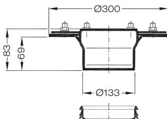
**Aufsatzelement mit Muffe**
